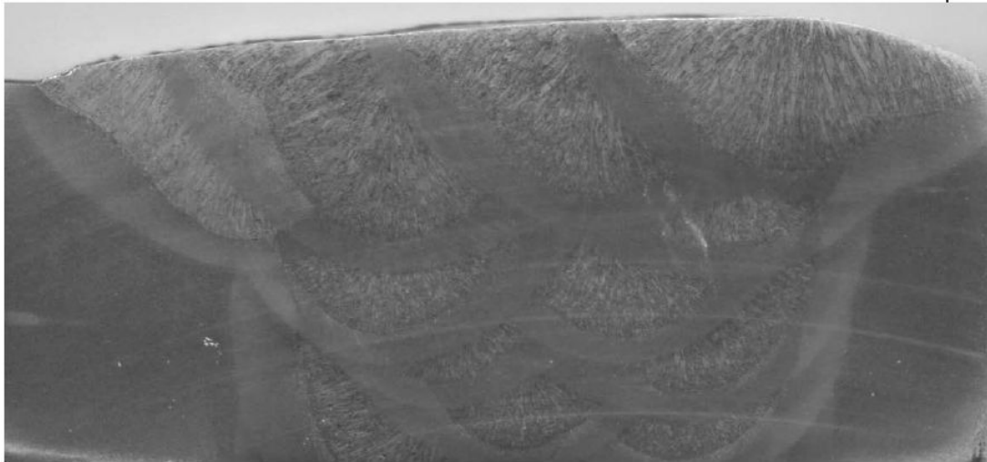
Fig. 8: Weld Macro Photograph – Specimen #7 Sl.8: Makrofotografija šava - epruveta #7
