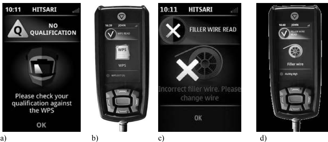
Slika 7. a) unos podataka za zavarivača, b) unos WPS liste, c) dodatni materijal nije odgovarajući za unetu WPS listu, d) upotrebljen odgovarajući dodatni materijal za unetu WPS listu
