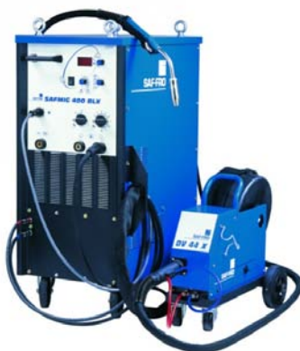
Slika 2) Aparat za zavarivanje SAF MIF 400 BLX.
