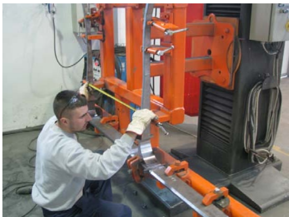
Slika 5. Provera dimenzija pre zavarivanja
