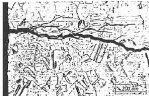
Slika 6. Prsline usled naponske korozije
