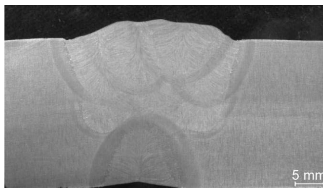
Slika 5 • Podužni presek šava zavarenog pod praškom sa impulsno modulovanom jednosmernom strujom (levo) i poprečni presek šava kod višeslojnog zavarivanja pod praškom sa impulsno modulovanom jednosmernom strujom (desno).
