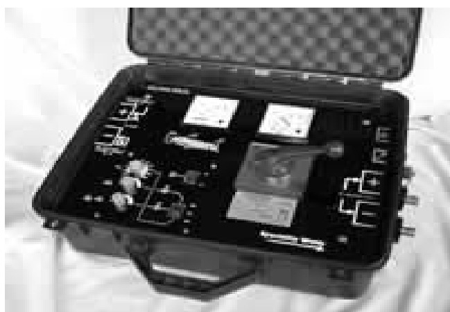
Slika 4. Kontrolni sistem za podvodno „točkasto“ zavarivanje [21]
