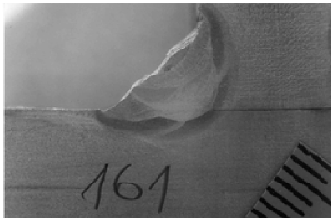
Slika 3. B klasa zavara prema AWS D3.6 [4]
