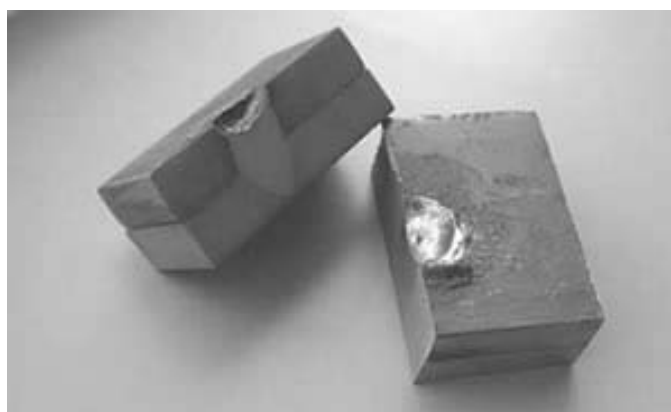
Slika 5. Podvodni zavar, «točkasto» zavarivanje
