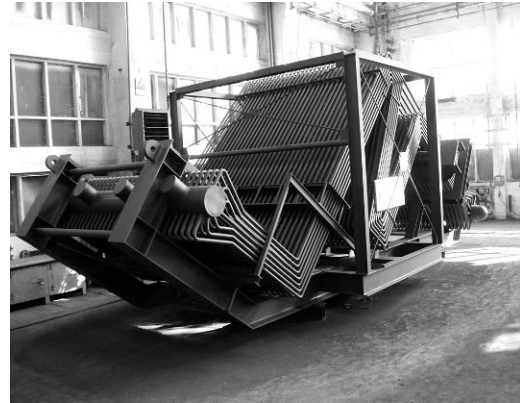
Figure 1. Overview of typical piping system "package" pipe snake and appearance of one of the superheater Slika 1. Pregled tipičnih cevnih sistema "paket" cevnih zmiija i izgled jednog od pregrejača
