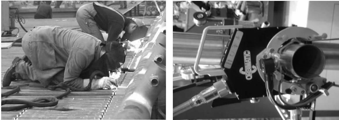
Figure 6. Left : Manual TIG welding. Right : Automated orbital TIG welding Slika 6. Levo; Ručno TIG , Desno; Automatsko orbitalno zavarivanje
