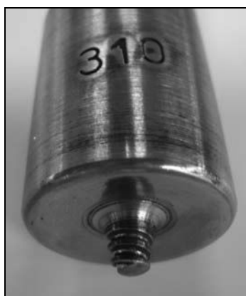
Slika 2. Alat oznake 310 korišćen za zavarivanje.
