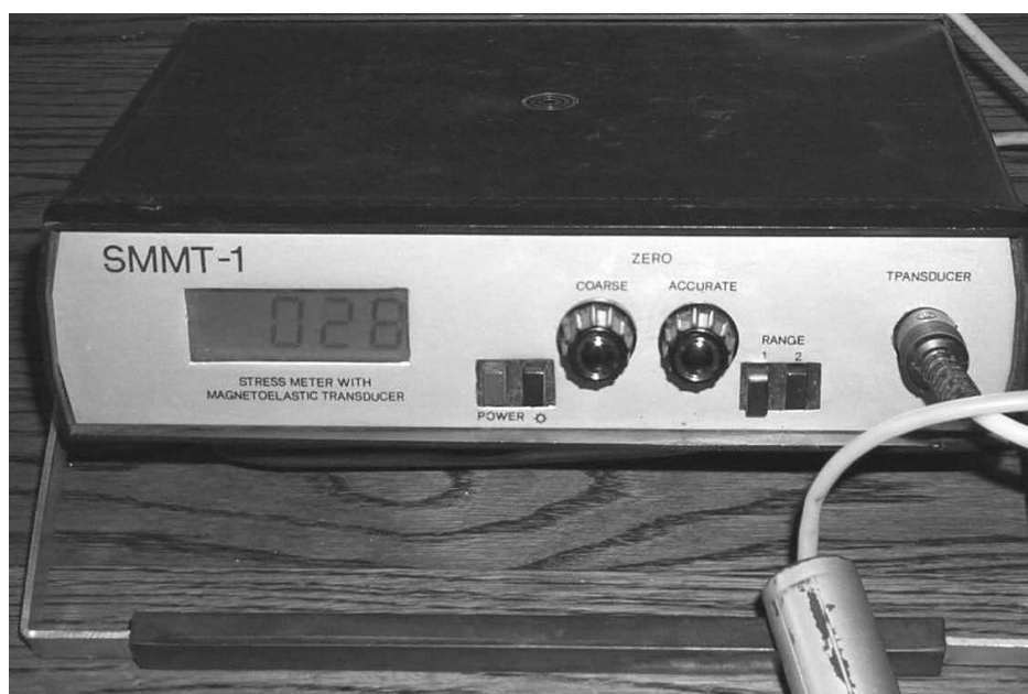
Slika 2. Uređaj za merenje zaostalih napona (SMMT-1)
