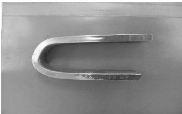
Fig. 6. A phenomena of non-axial deformation of bent samples Sl. 6 Pojava neaaksijalne deformacije savijenih uzoraka
