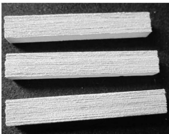
Slika 2. Uzorci AlMg6Mn legure nakon NAMLT testa.
