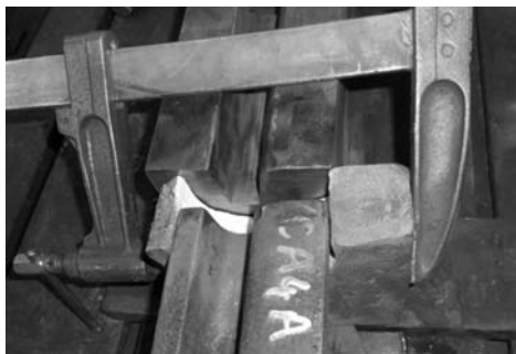
Slika 4. Pripreda za zavarivanje šape III prolaz
