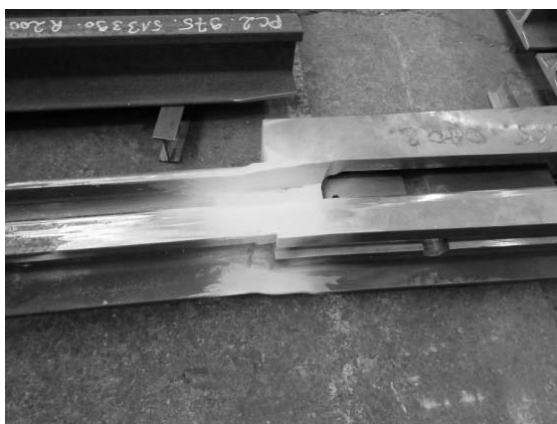
Slika 10. Izgled zavarenog spoja šina-blok
