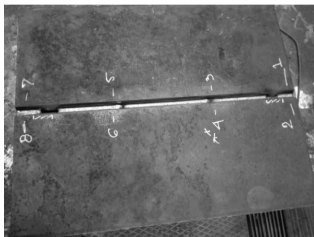
Figure 3. Root run with deliberately made imperfections Slika 3. Koreni zavar sa namerno napravljenim greškama
