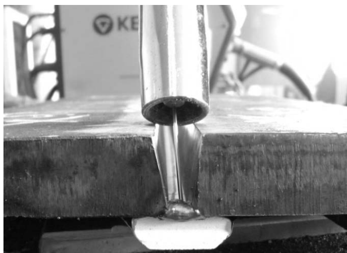
Figure 2. Increased free end length during narrow groove welding Slika 2. Povećana dužina slobodnog kraja tokom zavarivanja u uskom žlebu
