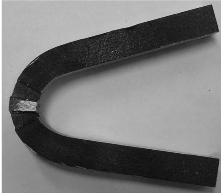
Figure 5. Sample tested at the bend Slika 5. Ispitana epruveta na savijanje
