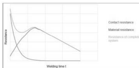
Figure 14. Time curves for electrical resistances during spot welding process Slika 14. Vremenske krive za električni otpor tokom procesa tačkastog zavarivanja
