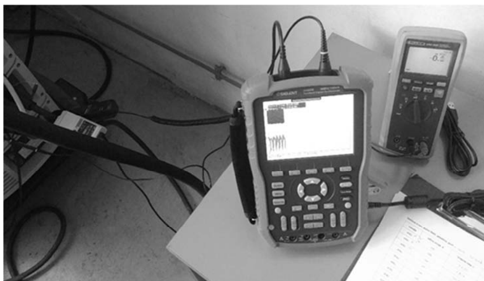
Slika 3. Povezivanje osciloskopa i strujnih kliješta na uređaj Welbee P500L
