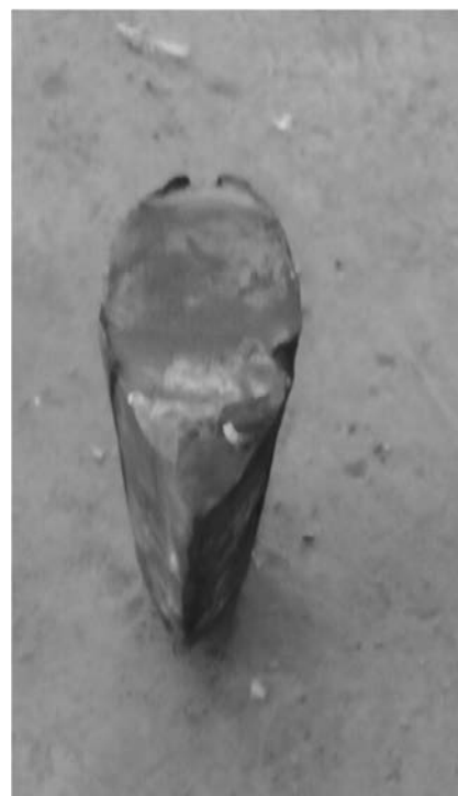
Slika 4. Priprema zuba za prenos na drugo vratilo kružnog kretanja bagera 10/70
