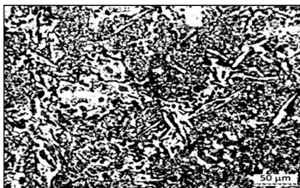
Slika 8. Mikrostruktura ZUT-a, 30 mm od površine navara (nagrizanje u nitalu 2%)
