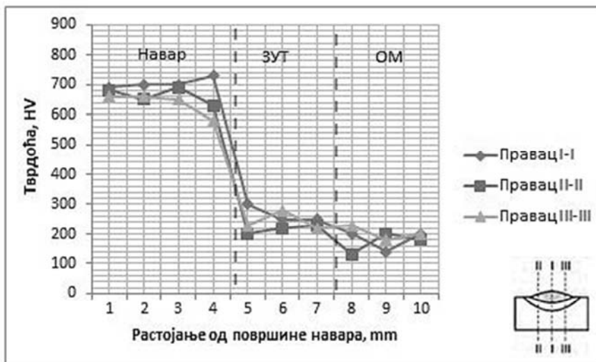
Slika 9. Raspodela tvrdoće po preseku navara: a) O.M.-S355J2G3, D.M. navara - FILTUB DUR 16
