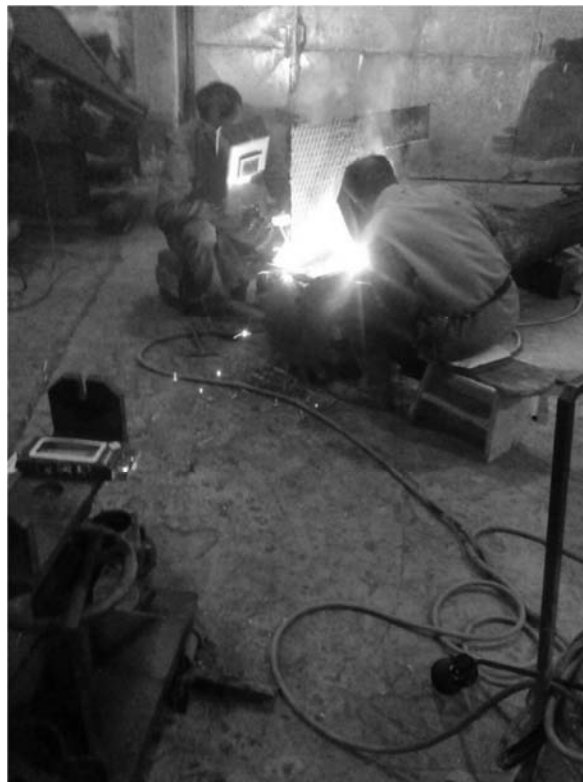
Slika 6. Predgrijavanje i zavarivanje vršeno simetrično u paru
