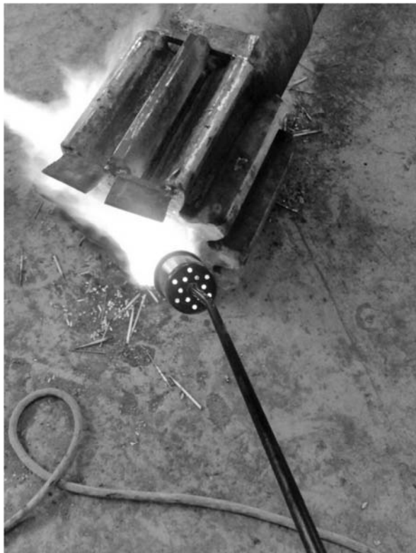
Slika 6. Predgrijavanje i zavarivanje vršeno simetrično u paru
