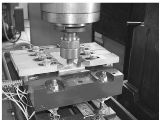
Slika 8. Prikaz početka procesa FSW
