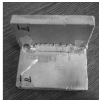
Slika 15. Zavareni ugaoni spoj
