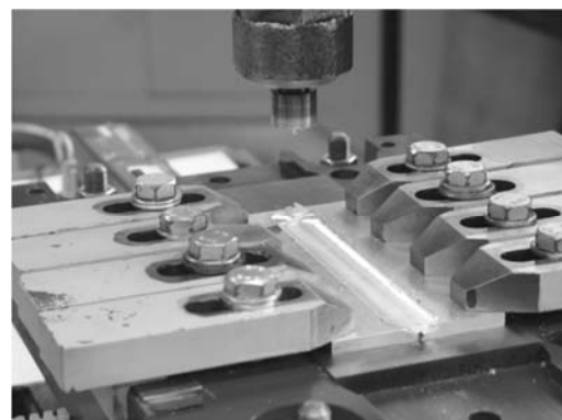
Slika 9. Prikaz završetka procesa FSW
