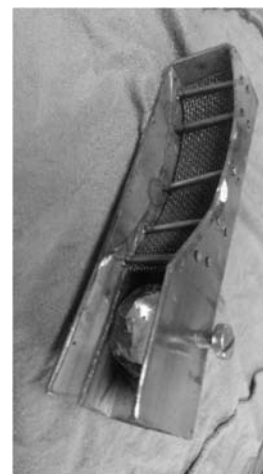
Slika 3. Alat – trag za sekundarnu zaštitu metala šava i ZUT-a
