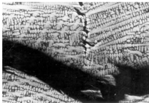
Slika 3. Tople prsline u MŠ zavarenih spojeva ugljeničnih čelika (uvećanje 400 puta)
