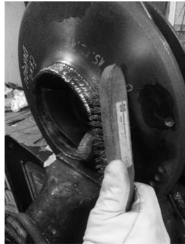
Slika 6. Četkanje nakon hlađenja, radi uklanjanja blagog oksida
