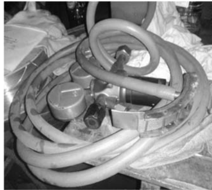
Slika 4. Alat za zaštitu korena vara
