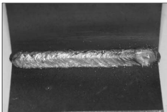
Slika 3. Izgled i presjek zavara za uzorak u položenoj poziciji ( Q=0,82 kJ/mm)
