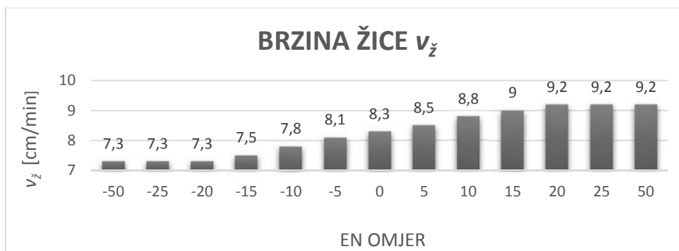
Slika 4. Ovisnost brzine dodavanja žice o EN omjeru
