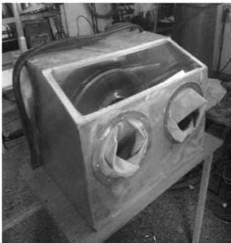
Slika 2. Komora za zavarivanje dimenzija 450 x 450 x 600mm
