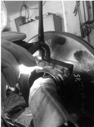
Slika 5. Prikaz procesa navarivanja
