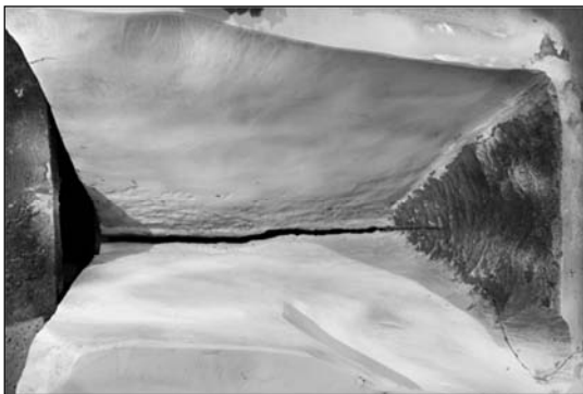
Slika 4. Ispitivanje penetrantima i pripremljeno ½ šava
