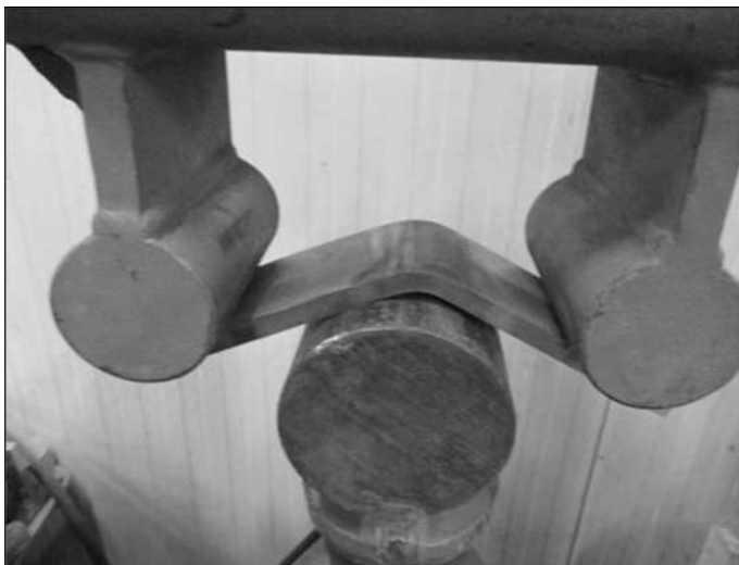
Slika 9. Savijanje korena zavarenog spoja
