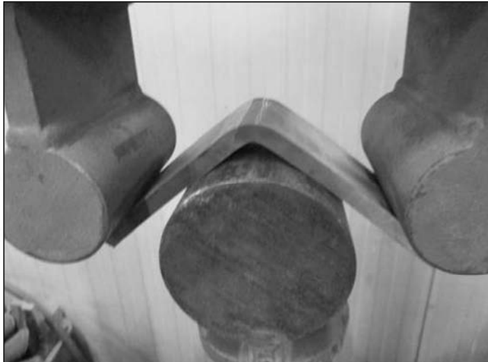
Slika 10. Savijanje lica zavarenog spoja
