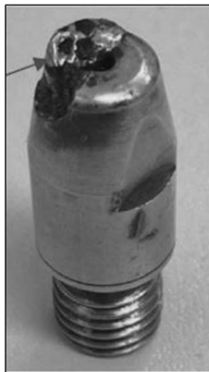
Figure 8. Damaged contact tip (nozzle) Slika 8. Oštećen kontaktni vrh (mlaznica)
