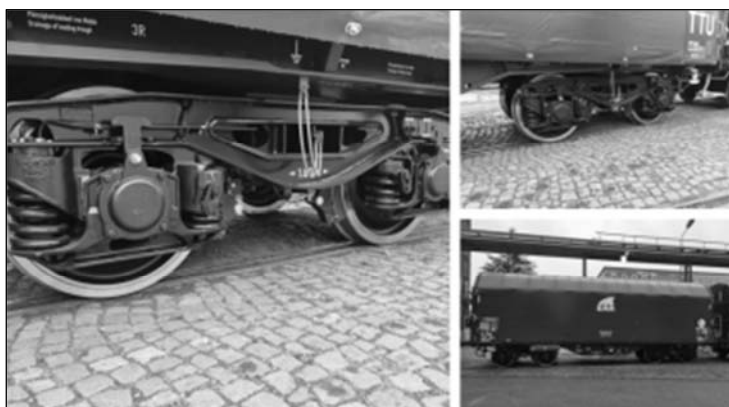
Slika 1. Okretno postolje u sklopu teretnog vagona
