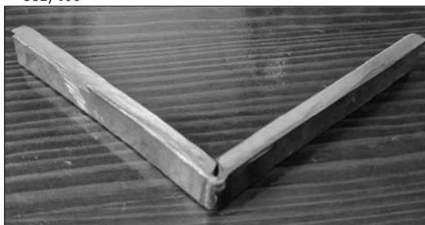
Slika 9. Ugao savijanja titana 83^\circ , (kriterijum prihvatljivosti savijanja 60^\circ )
