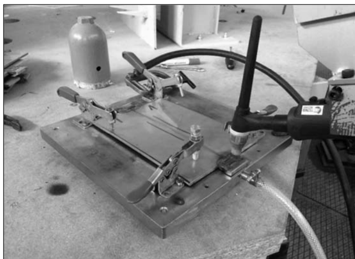
Slika 2. Priprema osnovnog materijala prije zavarivanje sa formiranjem korijena korišćenjem inertnog gasa argona sa donje strane
