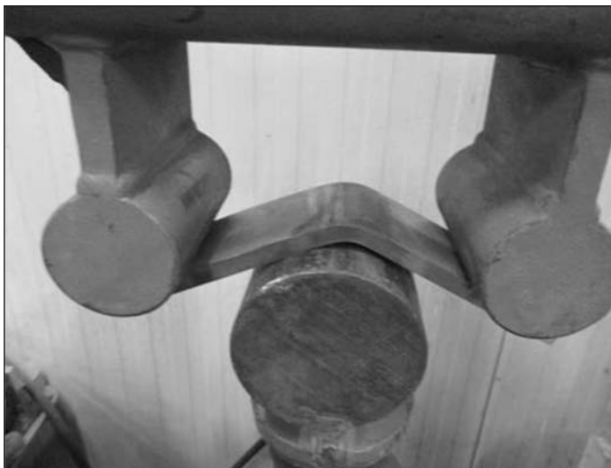
Slika 9. Savijanje korena zavarenog spoja
