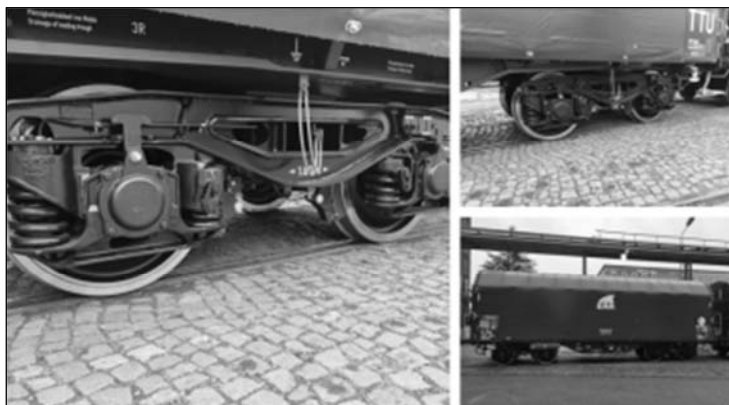
Slika 1. Okretno postolje u sklopu teretnog vagona
