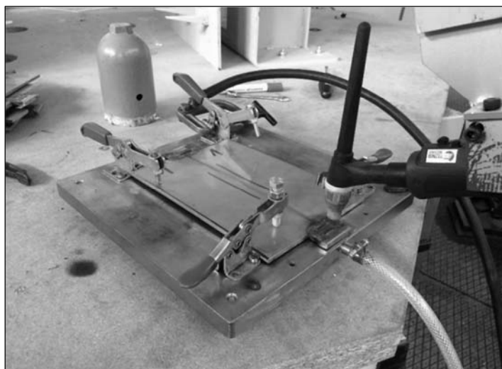
Slika 2. Priprema osnovnog materijala prije zavarivanje sa formiranjem korijena korišćenjem inertnog gasa argon sa donje strane
