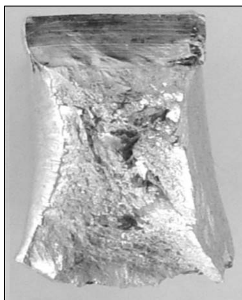
Slika 17. Prelomne površine šarpi uzorka za ATIG zavareni spoj pri korišćenju mješavine aktivirajućih topitelja BC-31 i QuickTIG (zeleni + bijeli)
