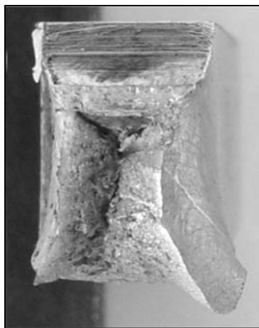
Slika 15. Prelomne površine šarpi uzorka za ATIG zavareni spoj pri korišćenju aktivirajućeg topitelja BC-31 (zeleni)
