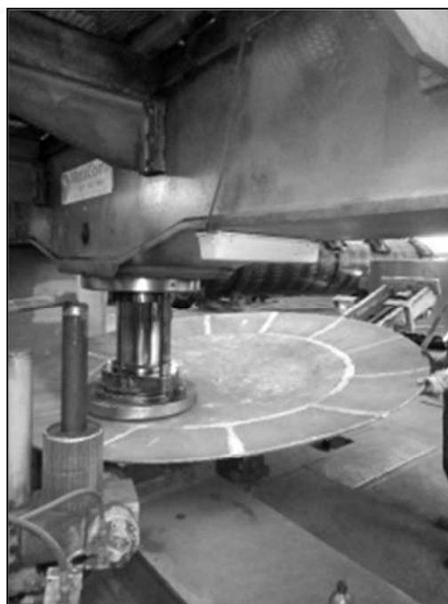
Slika 1. Izrada podnica postupkom inkrementalne deformacije
