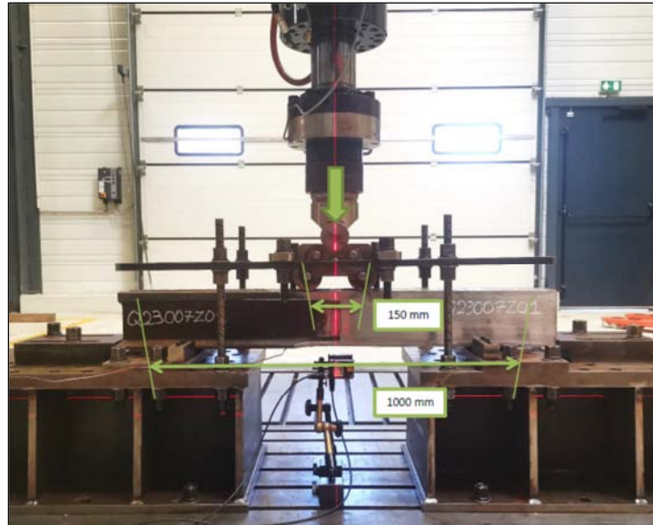
Slika 10. Ispitivanje zavarenog spoja savijanjem u četiri tačke.
