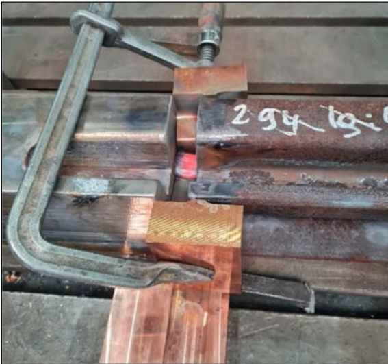
Slika 5. Zavareni vrat šine za blok
