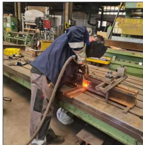
Slika 4. Zavarivanje šape šine za blok
