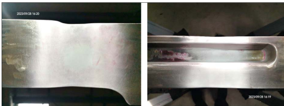
Slika 12. Izgled zavarenog spoja nakon ispitivanja na lom i ispitivanje penetrantima
