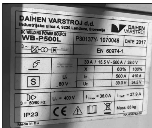
Slika 3. Tehničke karakteristike uređaja za zavarivanje
