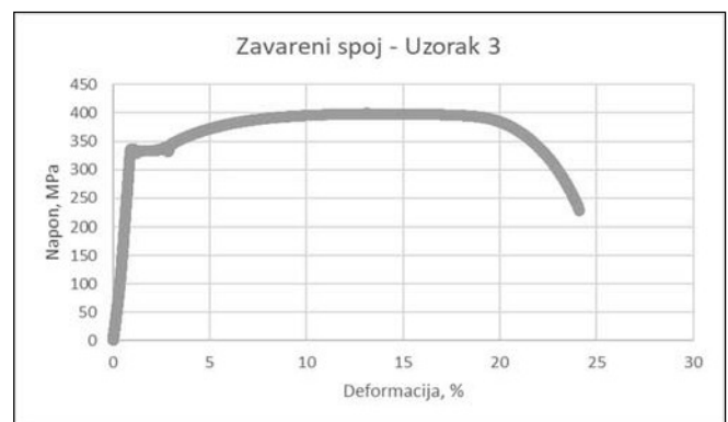
Slika 9. Prikaz dijagrama zatezanja dobijenih ispitivanjem zatezanjem
