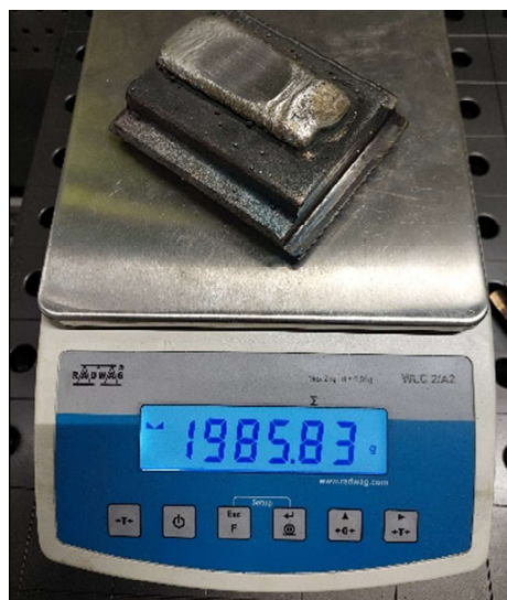
Figure 3. Position of the sample during abrasion test a), and weighing of the worn test sample b) Slika 3. Položaj uzorka tokom testa na habanje a), i merenje istrošenog uzorka za ispitivanje b)
