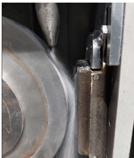
Figure 3. Position of the sample during abrasion test a), and weighing of the worn test sample b) Slika 3. Položaj uzorka tokom testa na habanje a), i merenje istrošenog uzorka za ispitivanje b)
