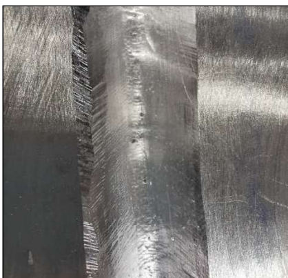
Slika 17. Linearna poroznost Figure 17. Linear porosity
