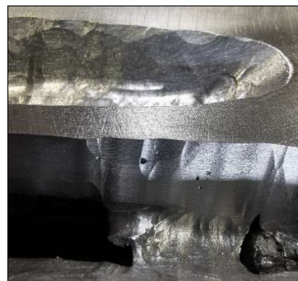
Slika 18. Grupisana poroznost/šupljine Figure 18. Cluster porosity/voids
