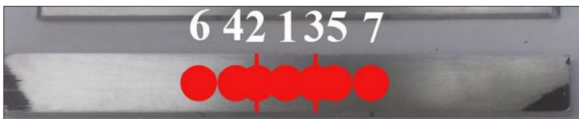
Slika 6. Lokacije merenja specifične provodljivosti. Vertikalne linije su linije stapanja (LS), a brojevi pokazuju sledeće merne lokacije: 1 – MŠ, 2 i 3 – na LS, 4 i 5 – sonda tangira LS, 6 i 7 sonda u OM. Prečnik sonde je iznosio 8 mm.
