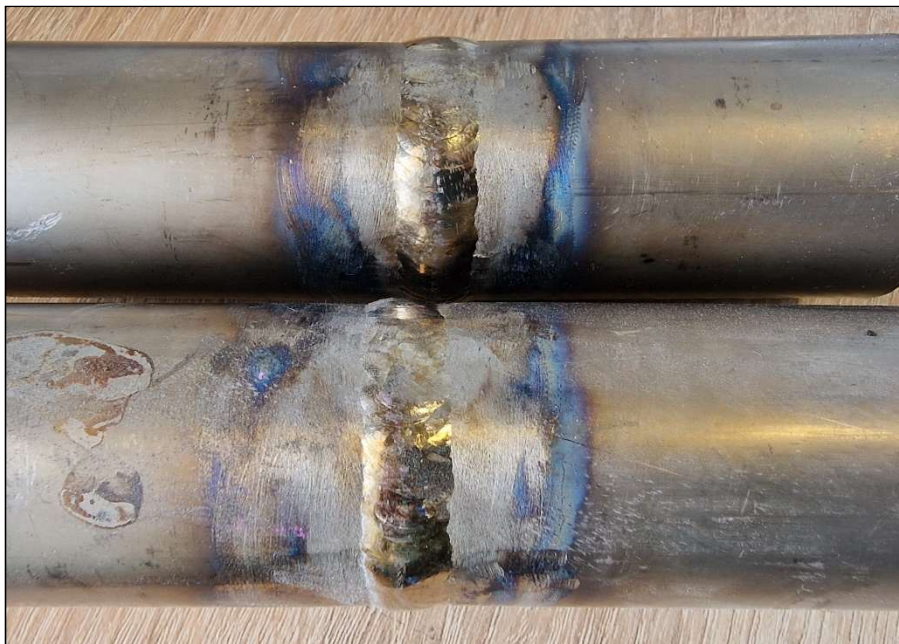
Slika 5: Fotografije zavarenog uzorka u PH (gornji uzorak) i PC položaju (donji uzorak)
