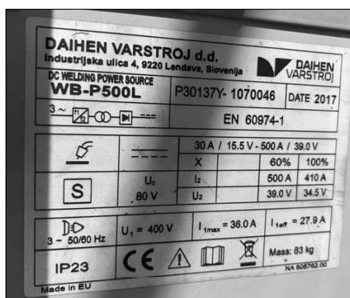
Slika 3. Tehničke karakteristike uređaja za zavarivanje
