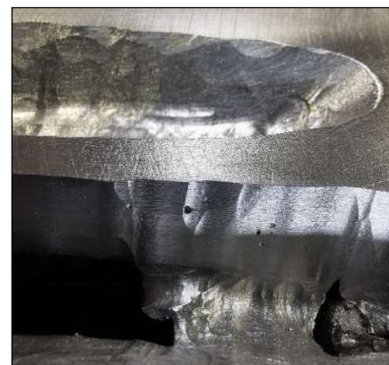
Slika 18. Grupisana poroznost/šupljine Figure 18. Cluster porosity/voids
