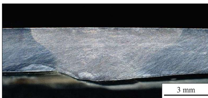
Figure 10: Specimen N° 10 - TAG, 210 A, filler wire 120 cm/min
