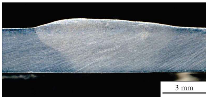
Figure 9: Specimen N° 9 - TAG, 210 A, filler wire 80 cm/min.
