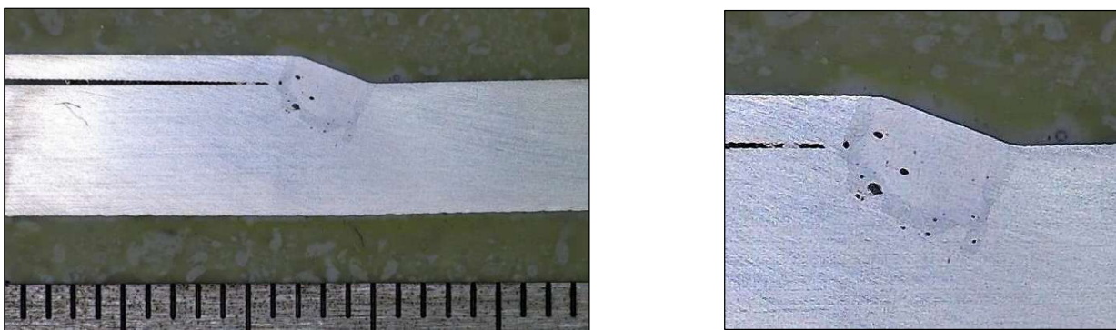
Slika 10. Makrostruktura uzorka zavarenog laserom, materijal W.Nr.1.4571 + W.Nr.1.4571 (lijevo) sa uvećanim detaljom pora (desno).
