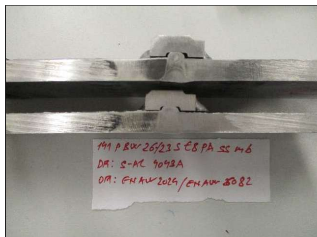
Slika 5. Makrostruktura zavarenog spoja rađenog sa korenom letvom: a) MIG; b) TIG.
