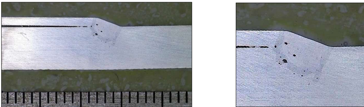
Slika 10. Makrostruktura uzorka zavarenog laserom, materijal W.Nr.1.4571 + W.Nr.1.4571 (lijevo) sa uvećanim detaljom pora (desno).
