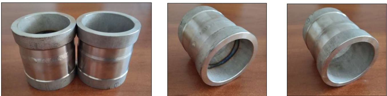
Slika 8. Zavareni uzorci iz materijala X6CrNiMoTi17-12-2 (W.Nr. 1.4571), a) Vizualna usporedba uzoraka TIG (lijevo) i laser (desno), b) Uzorak zavaren TIG-om sa izraženom pobojenosti sa unutrašnje strane i c) Uzorak zavaren laserom bez pobojenosti.
