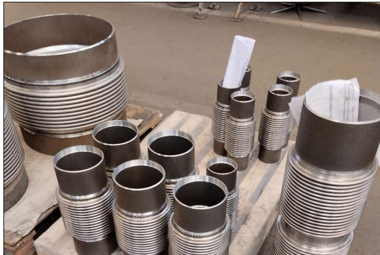
Slika 5. Detalj pripreme za zavarivanje tankostijene harmonike na cijevne nastavke.
